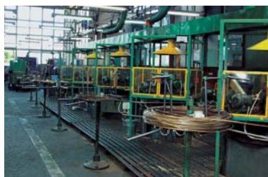
Automaty do produkcji zacisków. Automatic machines for production connectors.
