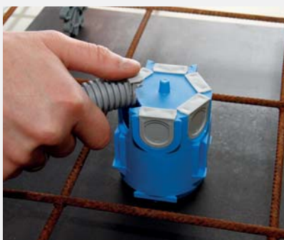
4. Osadzić peszel lub rurę klinując od góry brzegiem odciętej wkładki lub wkładkami opcjonalnymi - P597 do rur M25 lub P598 do rur M20.
