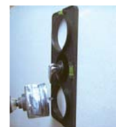
Precyzyjnie wyrównaj szablon przy użyciu poziomic na jego obrzeżu.
